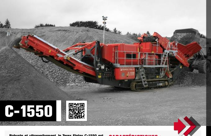
Robuste et ultraperformant, le Terex Finlay C-1550 est un concasseur giratoire spécialement conçu pour les applications d'agrégats et d'exploitation de carrière. Le concasseur à cône Terex Finlay C-1550 est équipé du Terex® 1300, concasseur giratoire à entraînement variable direct dont la réputation n'est plus à faire. Il est lui-même équipé du système de relâchement automatique et de la fonction de réglage hydraulique du serrage.
