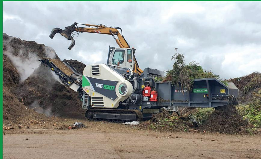
Grâce à sa mise en place rapide, le TBG 530T est prêt à fonctionner en quelques minutes sans avoir à utiliser d'outil. La trémie d'alimentation ouverte en façade permet de charger le TBG 530T rapidement et facilement par l'arrière. Le système d'alimentation à commande intelligente, composé de chaînes de traînage renforcées et d'un rouleau d'alimentation dynamique doté d'une assistance unique pour le levage/l'abaissement, assure un flux de matériau optimal pour des performances de pointe.
