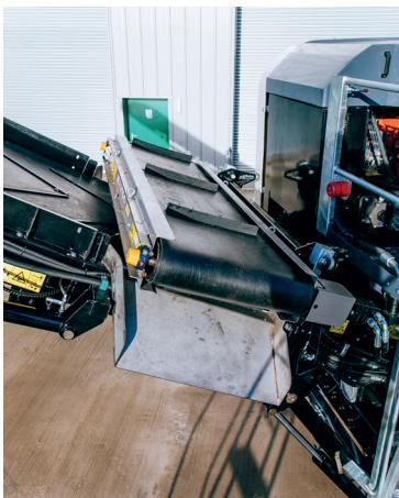
Aimant overband haute résistance avec réglage hydraulique de la hauteur (en option)
