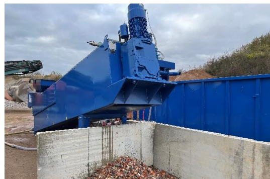
Déchargement des matériaux lourds HDS-WV
